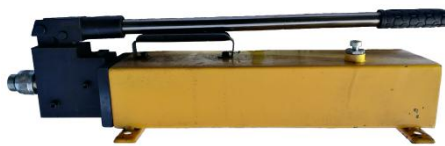
图 A. 2 手动液压泵
